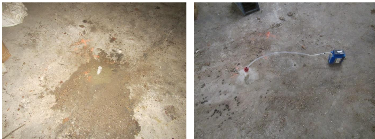
Figure 18 : Implantation des piézairs et prélèvements des gaz des sols
